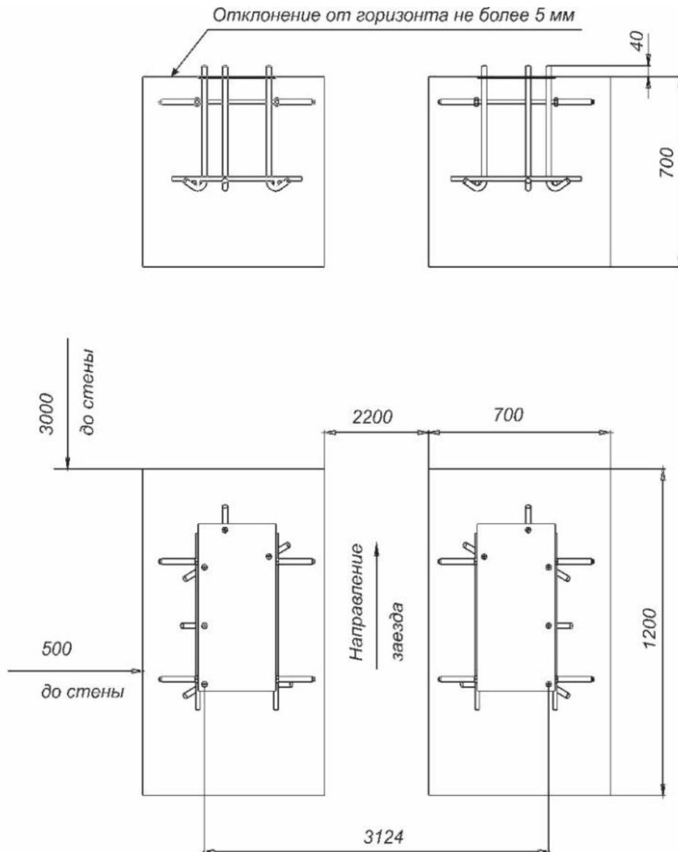
Рисунок 7 Схема оборудования фундамента
