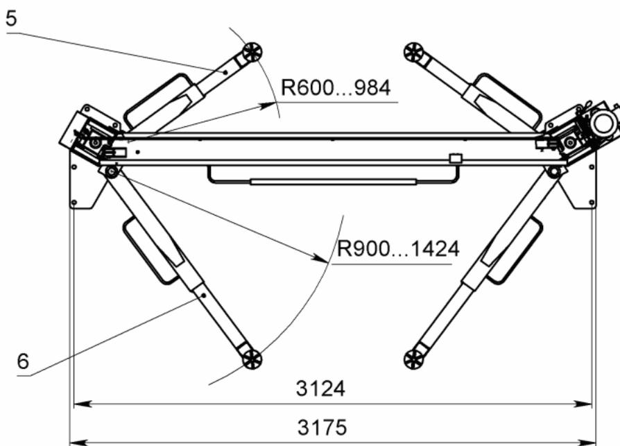
Рисунок 1. Общий вид подъемника
