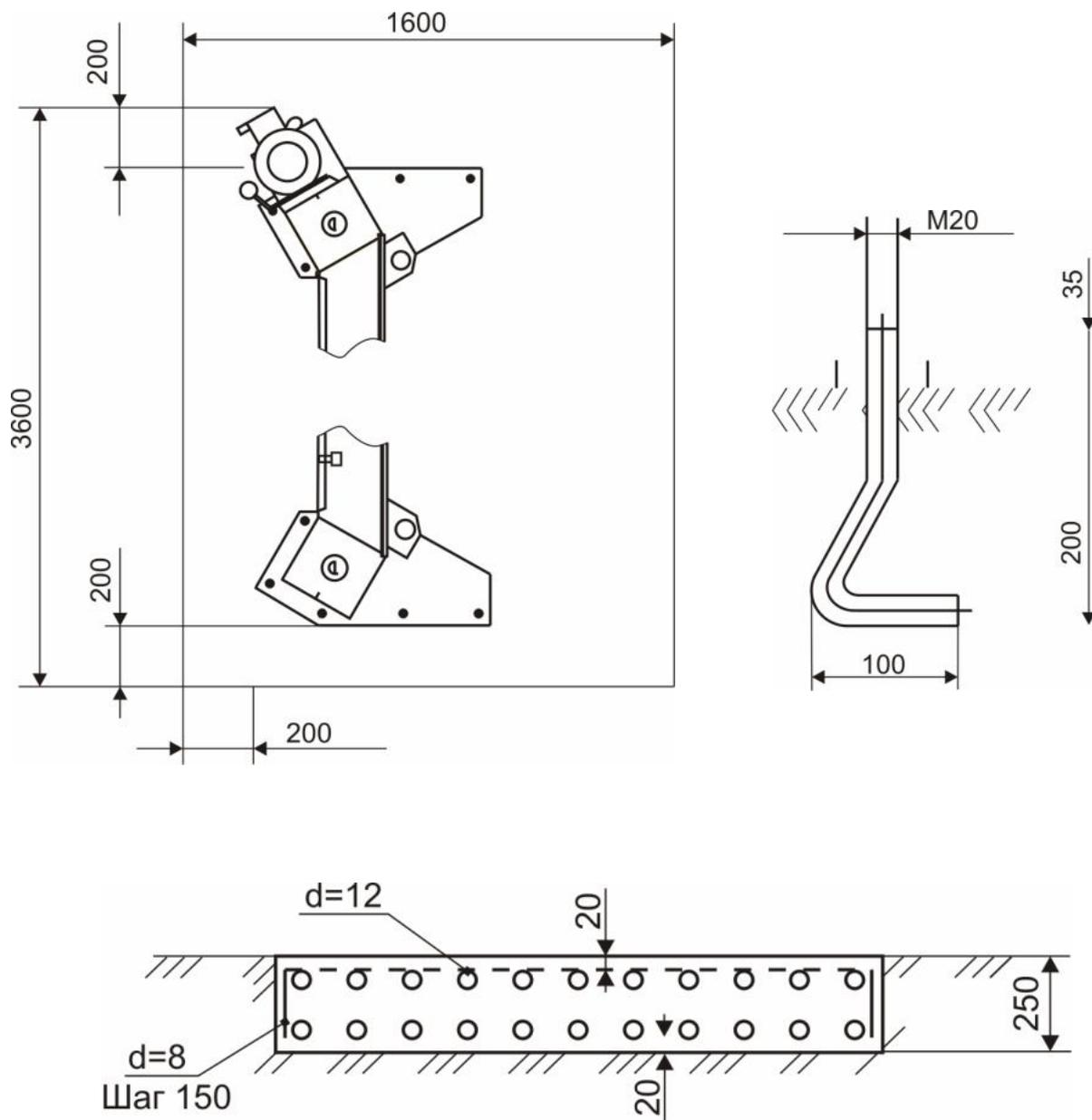
Рисунок 6. Схема оборудования фундамента
